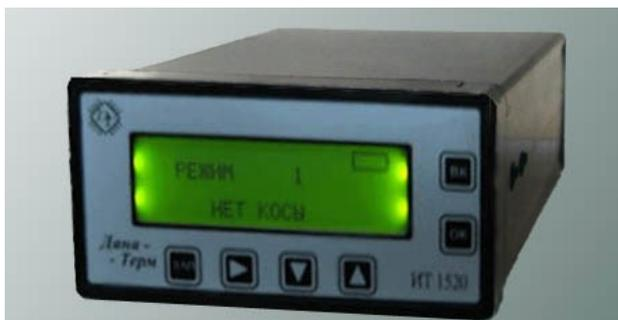
Измеритель температуры ТЦМ1520 в комплексе с блоком реле БР1 образуют десятиканальный ПИД регулятор, использующий в качестве первичных датчиков **термопреобразователи термоэлектрические (термопары)** и **термопреобразователи сопротивления**. Применяется в тех областях технологических процессов, где требуется повышенная точность поддержания температуры. Применяется в тех областях технологических процессов, где требуется повышенная точность поддержания температуры.
