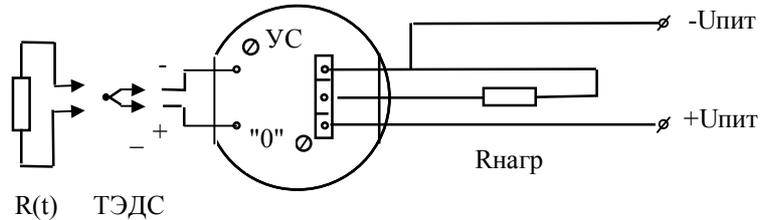
Нормирующий усилитель (НУ) предназначен для преобразования сигнала от первичного термопреобразователя в унифицированный выходной сигнал постоянного тока при измерении температуры в различных отраслях промышленности
