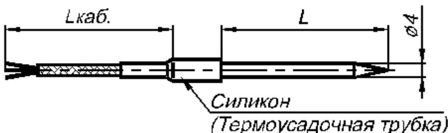
Пример записи при заказе: ТС141, Pt100, L=100, Lкаб.=2000
